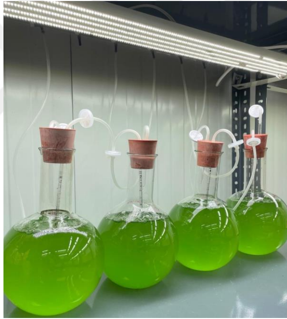
Şekil 3.1. Çalışmada kullanılan kesikli tip fotobiyoreaktörler.
