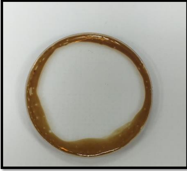
Şekil 2.6. Yağ yayılma sonucunda biyosüpfektan pozitif durum.
