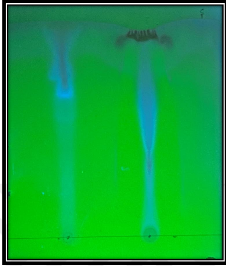
Şekil 4.17. Biyosürfektan fraksiyonlarının TLC plakasında gözlenmesi.
