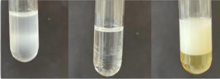
Şekil 3.3. Biyosürfektan varlığının E_{24} yöntemi ile belirlenmesi.
