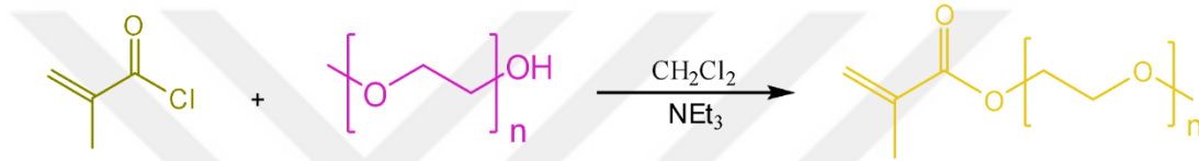
Şekil 40. M 1 hidrofilik monomerin sentez reaksiyonu.
