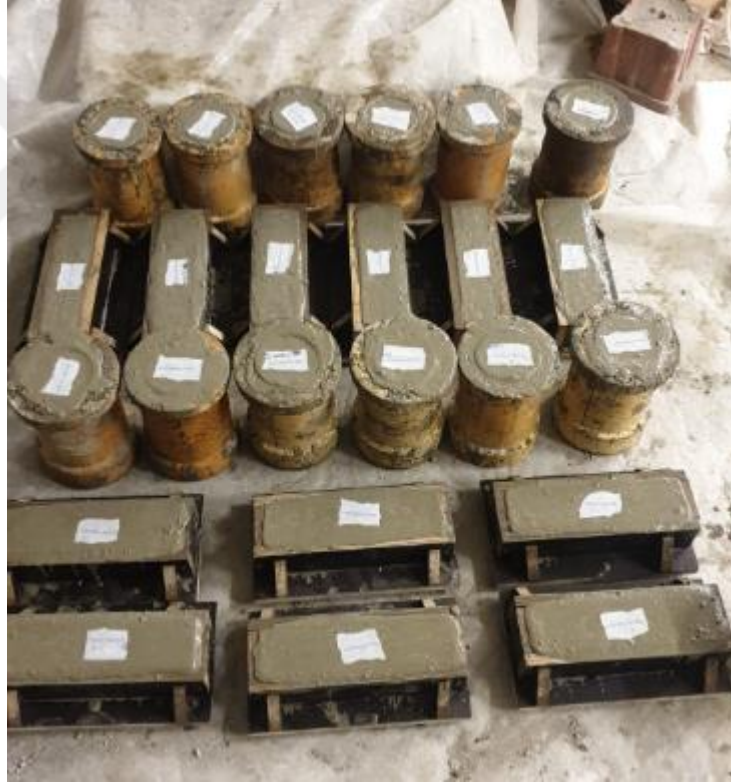
Şekil 2.1 : Beton döküm aşaması.
