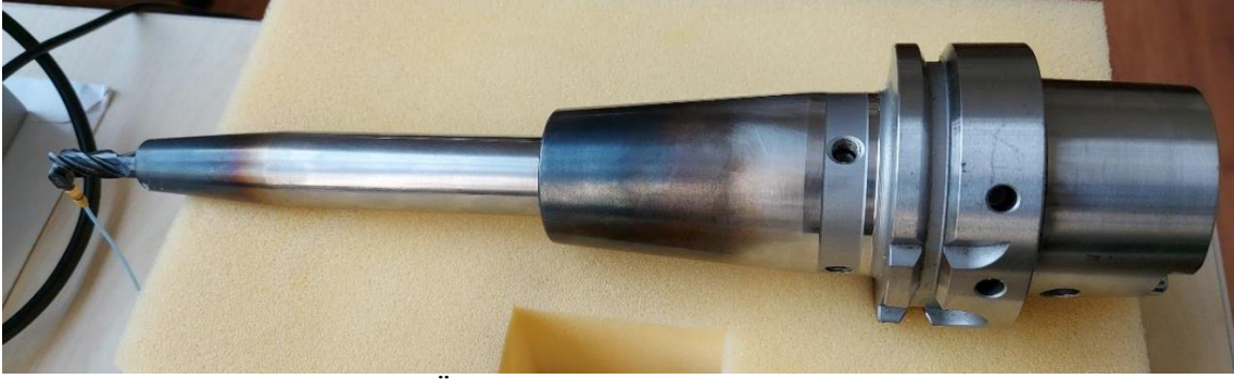
Şekil 3.14. Örnek takım tutucu pens (Altın, 2023)
