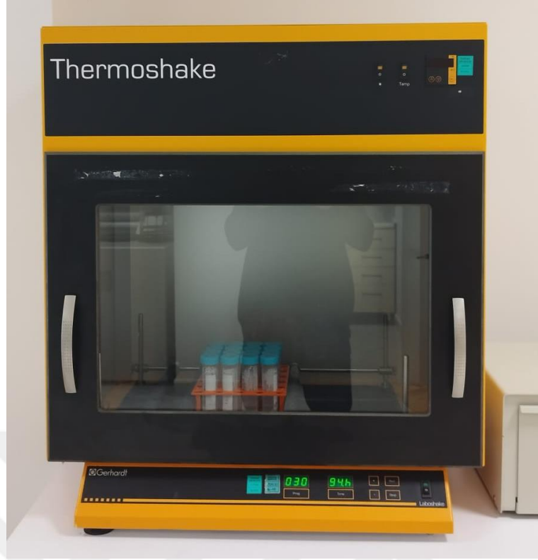
Şekil 3.20. Plakalar sürekli çalkalamalı sistemde laktatlı ringer çözeltisinde.
