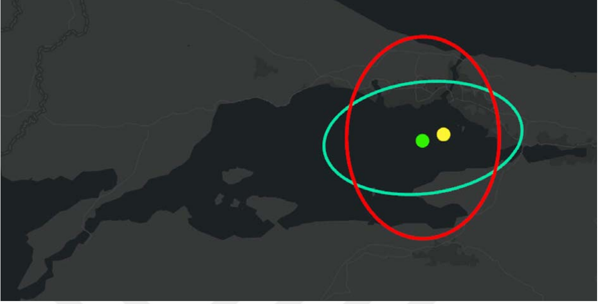
Şekil 17: Veri kümesindeki balıkçılık eforu noktaları için standart mesafe (kırmızı daire), yön dağılımı (yeşil daire), ortalama merkez (yeşil nokta) ve ortanca merkez (sarı nokta).
