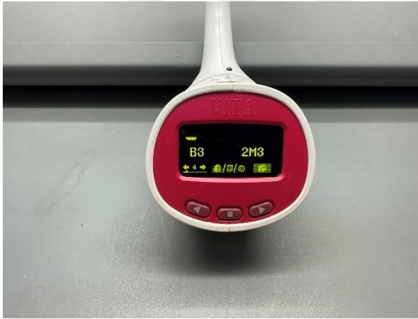
Şekil 31. Spektrofotometre ile renk ölçümü
