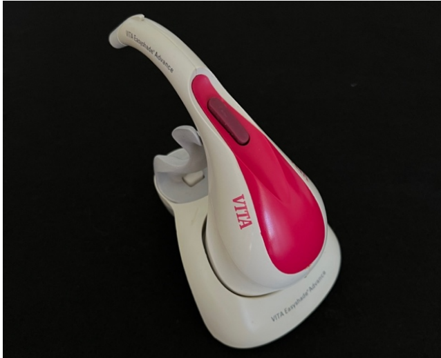
Şekil 3.6.1: Çalışmada kullanılan renk ölçüm cihazı
