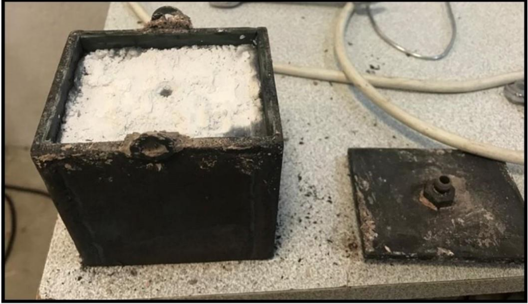
Şekil 5.11: Boro-Sinterleme sonrası kutunun soğumaya bırakılması.
