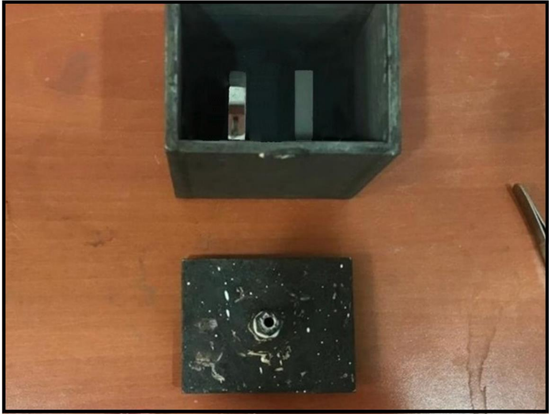
Şekil 5.8: Boro-Sinterleme kutusuna numunelerin dizilişi.
