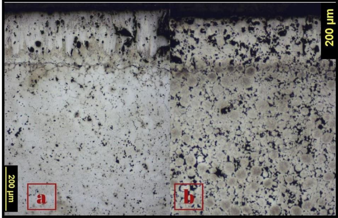
Şekil 6.14: 1050°C’de 4 saatlik Boro-Sinterleme sonrası OM görüntüleri (a) ÖSB1050-4 kodlu numune, (b) ÖSB1050-4 kodlu numune.
