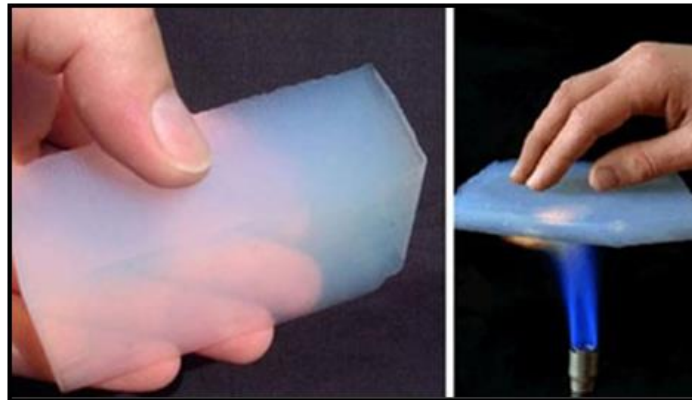
Şekil 2.2. Aerojel malzemesi ve ısıya dayanıklılığı
