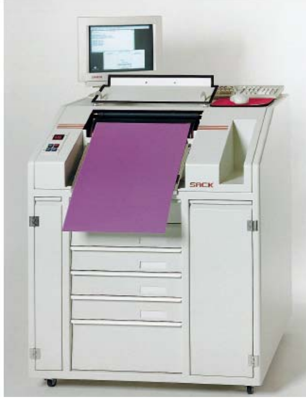
Şekil IV.7 CtP sisteminde Dış tamburlu kalıp pozlama makinası (Sack0520) (6)
