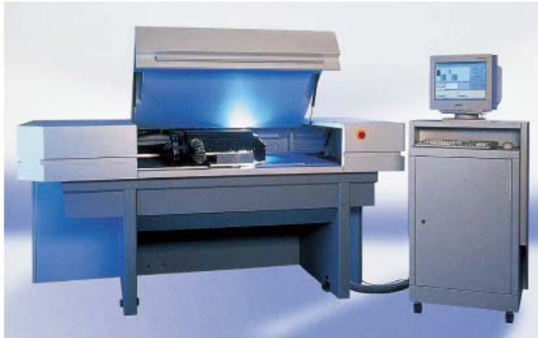
Şekil IV.5 CtP sisteminde Düz yataklı kalıp pozlama makinası UV hassas kalıplar için (UV Setter 710, basysprint) (6)
