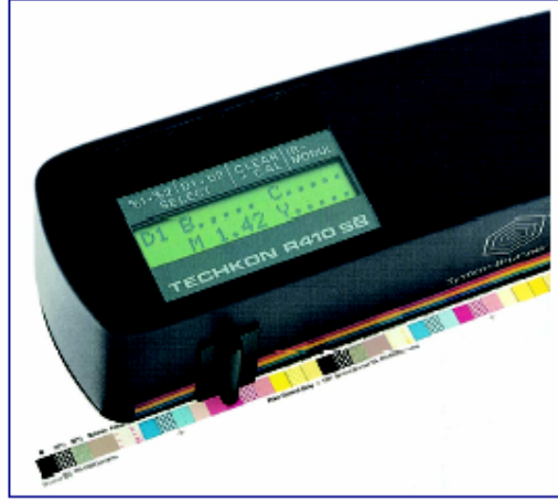
Şekil VI.1 Kalite Kontrol Cihazları Densitometre ölçüm aleti
