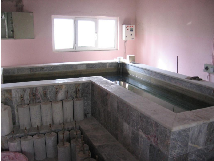
Şekil 5.9. Beton kür havuzu
