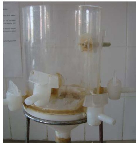
Şekil 3.9. Çalışmada kullanılan Hareketli Yatak Biofilm Reaktör, çökeltme tankı ve boyutları
