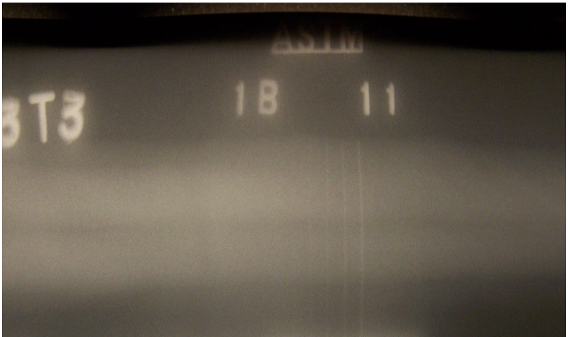
Şekil 5.3. WT3 numunesi radyografik test gama-ray film sonucu.
