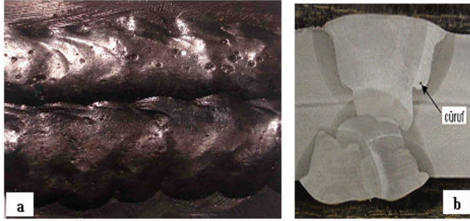
Şekil 5.11. WG4 numunesi üstten (a) dikiş yapısı ve (b) makroyapı fotoğrafı
