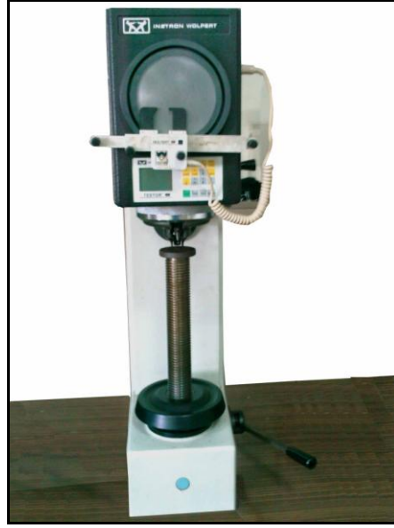
Şekil III. 5 Instron Wolpert marka sertlik ölçme cihazı
