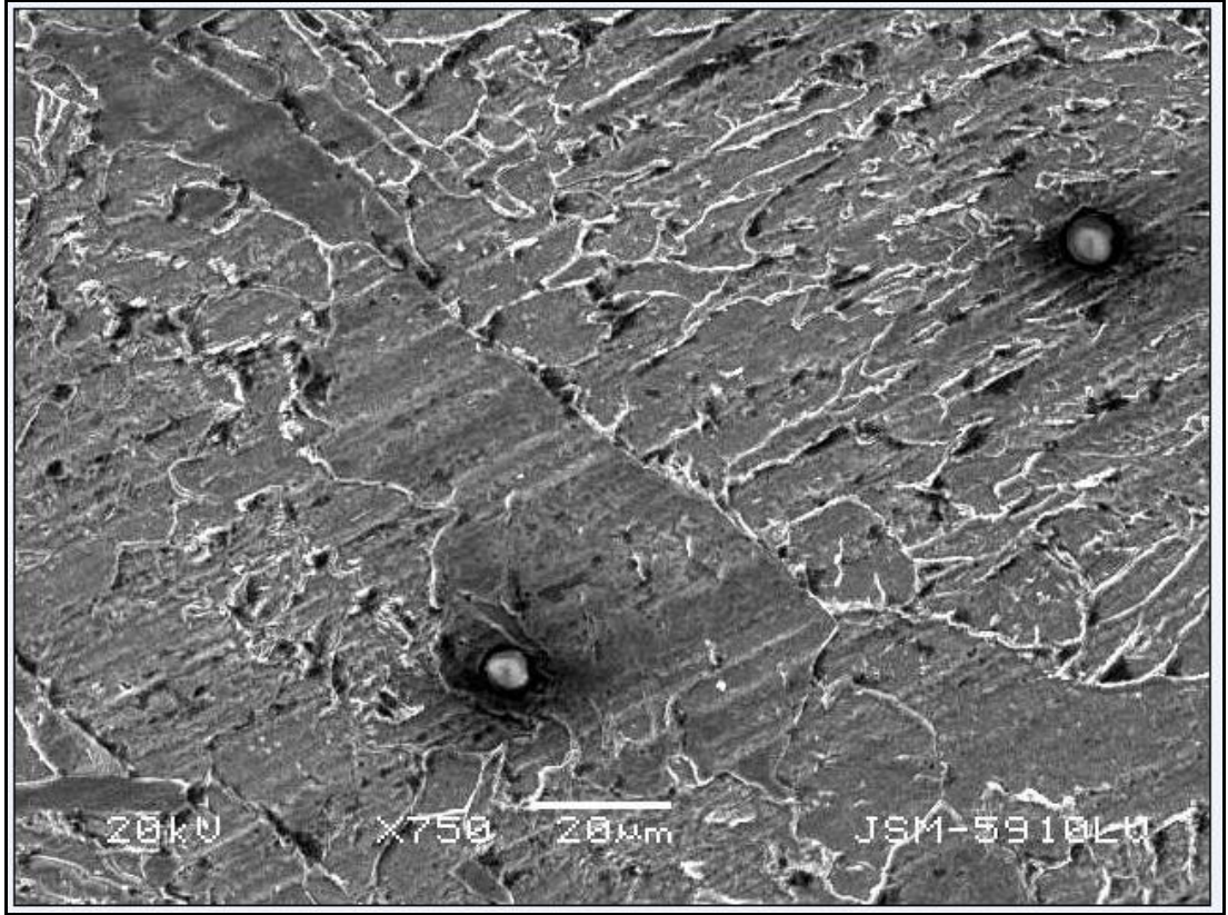
Şekil IV. 23 Isıl işlem öncesi StE 26 kaynak metali SEM görüntüsü (X750)
