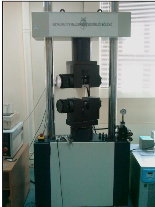
Şekil III. 7 DARTEC marka çekme deneyi makinesi
