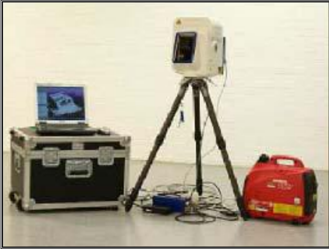
Şekil 2.2 : MENSİ GS 100 Yersel Lazer Tarama Sistemi
