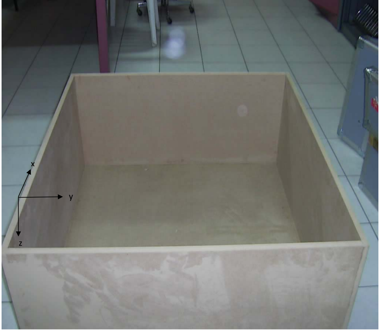
Şekil 5.61 FDTD algoritmasında ve deneylerde kullanılan kasa ve x,y,z boyutları
