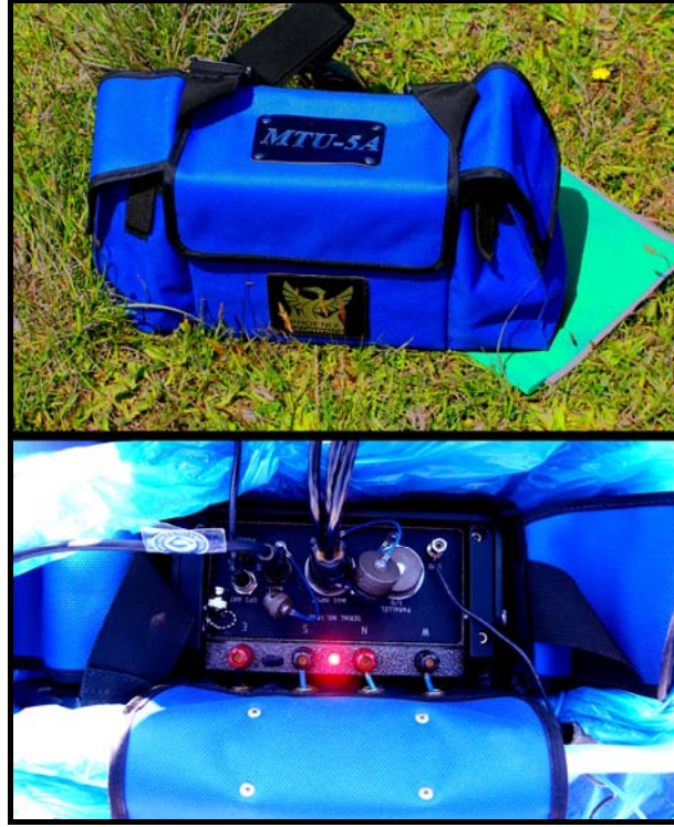
Şekil 3.10: MTU 5A Manyetotelürik ölçüm cihazı kayıtcısı
