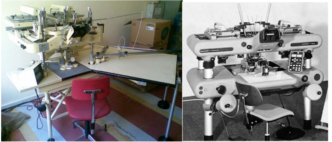
Şekil 2.2 : Sol resimde analog fotogrametrik, sağ resimde ise analitik fotogrametrik sistemlere ait örnekler
