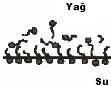
Şekil 3.4 Emülgatör molekülünün su yağ arayüzeyinde yönelmesi [3]
