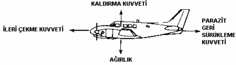
Şekil 2.4. Uçuşta Bir Uçağın Bütününe Etki Eden Kuvvetler.
