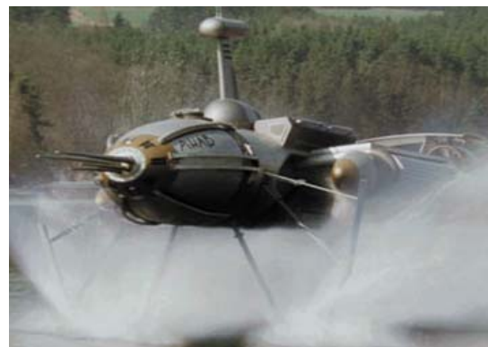
Şekil 2.12 Yüzeye dik kayaklı hidrofoyl [ Buyan, 2008 ].
