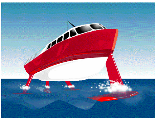
Şekil 2.11 Kayakları su yüzeyinin altı [ Buyan, 2008 ].
