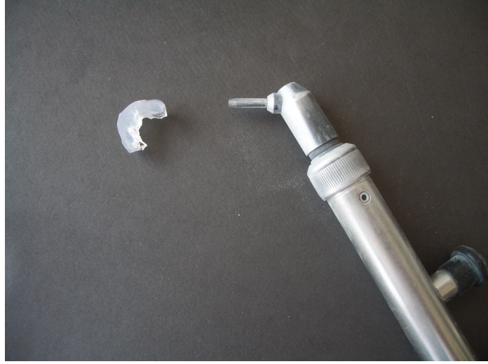
Şekil 3-15: Silikon taşıyıcı içindeki braket tabanının kumlanması.
