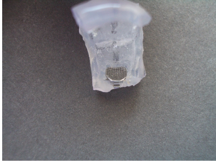
Şekil 3-16: Kumlanmış braket tabanının gingival yönden görüntüsü
