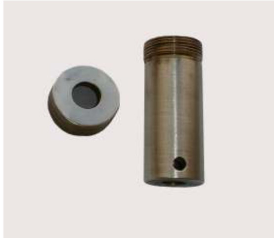
Şekil 3-9: Hazırlanan akrilik blokların test cihazına bağlanmasını sağlayan adaptör.
