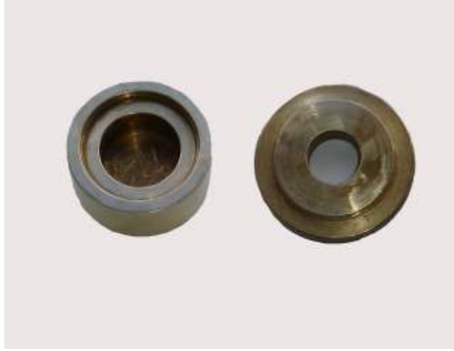
Şekil 3-8: Akrilik ve alçı blokların hazırlanmasında kullanılan metal kalıp.
