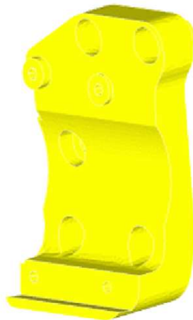
Şekil 1.4. Topoloji optimizasyonu için kullanılan kompresör braketini
