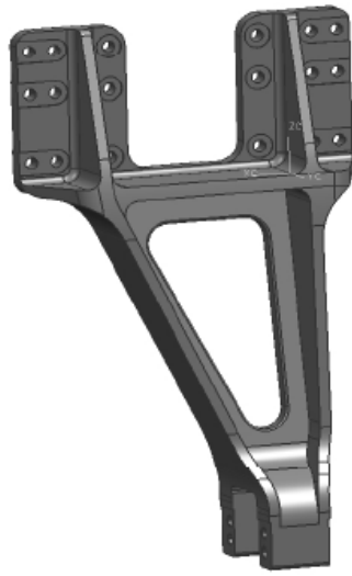
Şekil 1.8. Topoloji optimizasyonu çıkan konsept model
