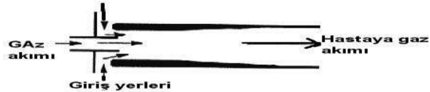
Şekil 4. 9 Venturi Enjektörü
