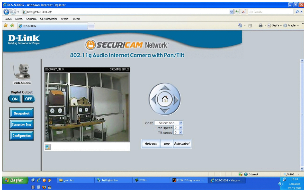
Şekil III.14 IP Kamera Yapılandırma Ekranı
