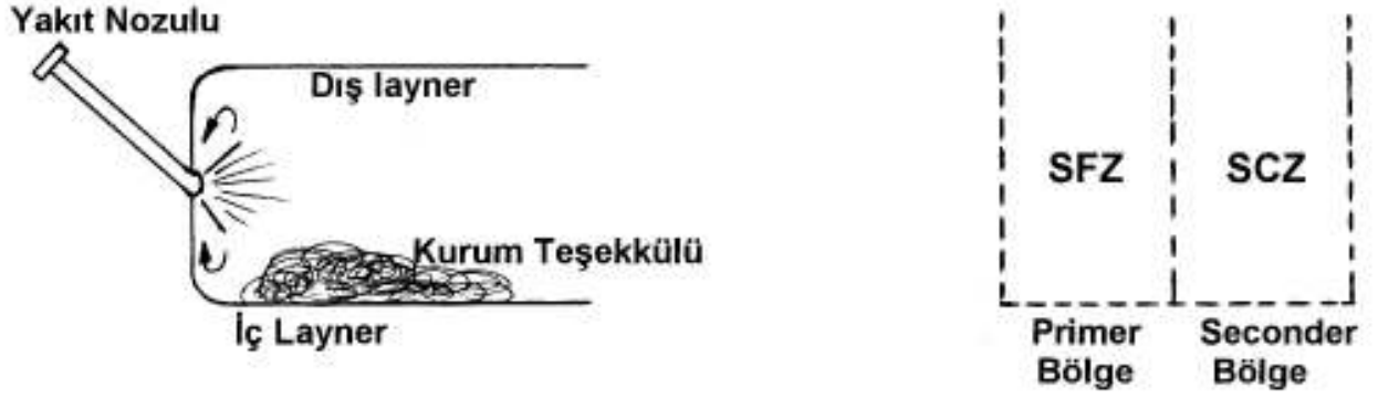
Şekil 3.11. Yanma Odasında Kurum Teşekkülü
