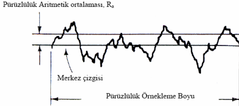
Şekil III.6. Yüzey Pürüzlülüğü Aritmetik Ortalaması
