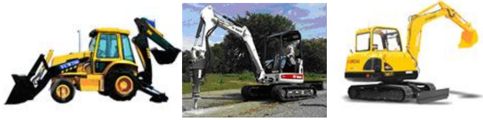
Resim 2.12 Yıkımda kullanılan mini makineler [MTK İnşaat, 2008]
