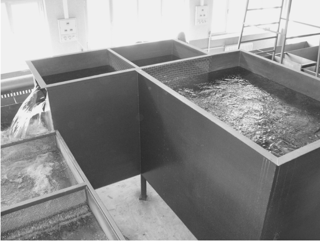
Şekil 4.4 Dinlendirme havuzu ve üçgen savak genel görünüşü
