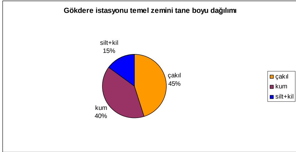
Şekil 3.9: Gökdere İstasyonu temel zemini tane boyu dağılımı
