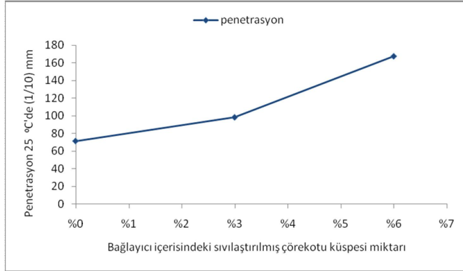
Şekil 4.2. Bitümlü bağlayıcı içerisine karıştırılan sıvılaştırılmış çörekotu miktarının penetrasyon değerindeki değişimi
