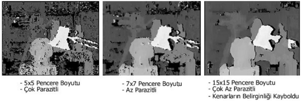
Şekil 2.11 Farklı pencere boyutları ile denenmiş ilişki temelli eşleme algoritmasının sonuçları
