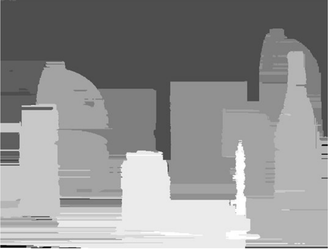
Şekil 3.18 Güvenilir bölgelerin yatay yönde yayılması sonucu elde edilen yeni stereo uzaklık haritası
