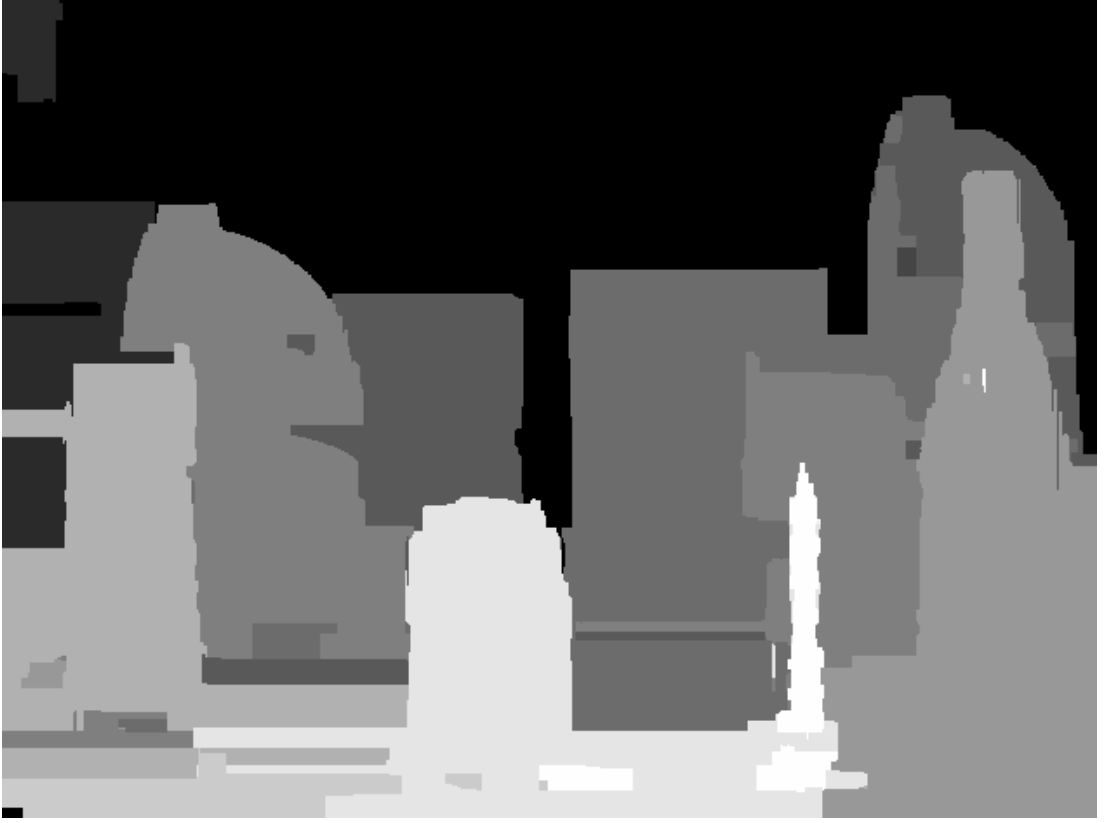
Şekil 3.19 Dikey yönde filtre uygulanmış stereo uzaklık haritası
