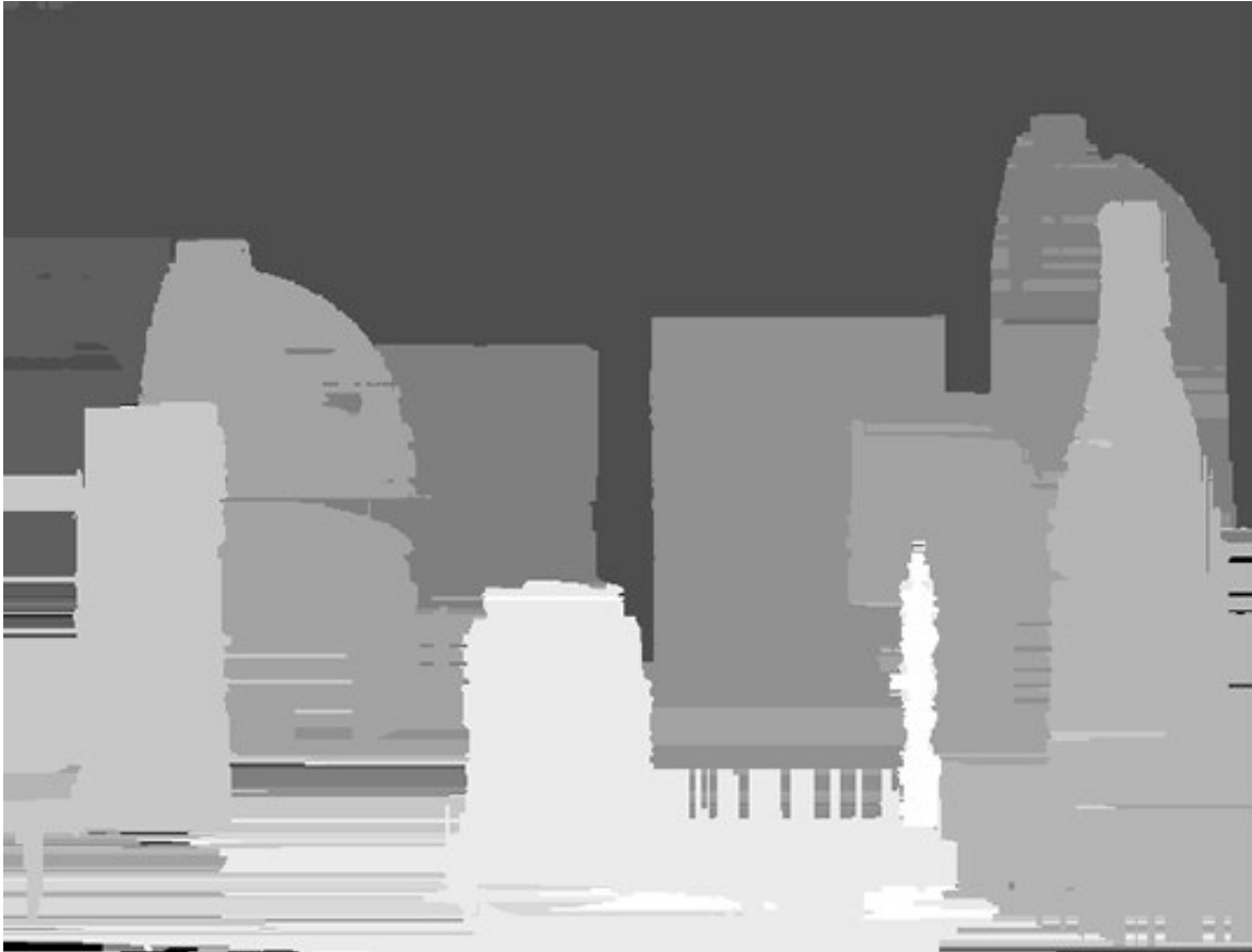
Şekil 3.17 Güvenilir bölgelerin dikey yönde yayılması sonucu elde edilen yeni stereo uzaklık haritası
