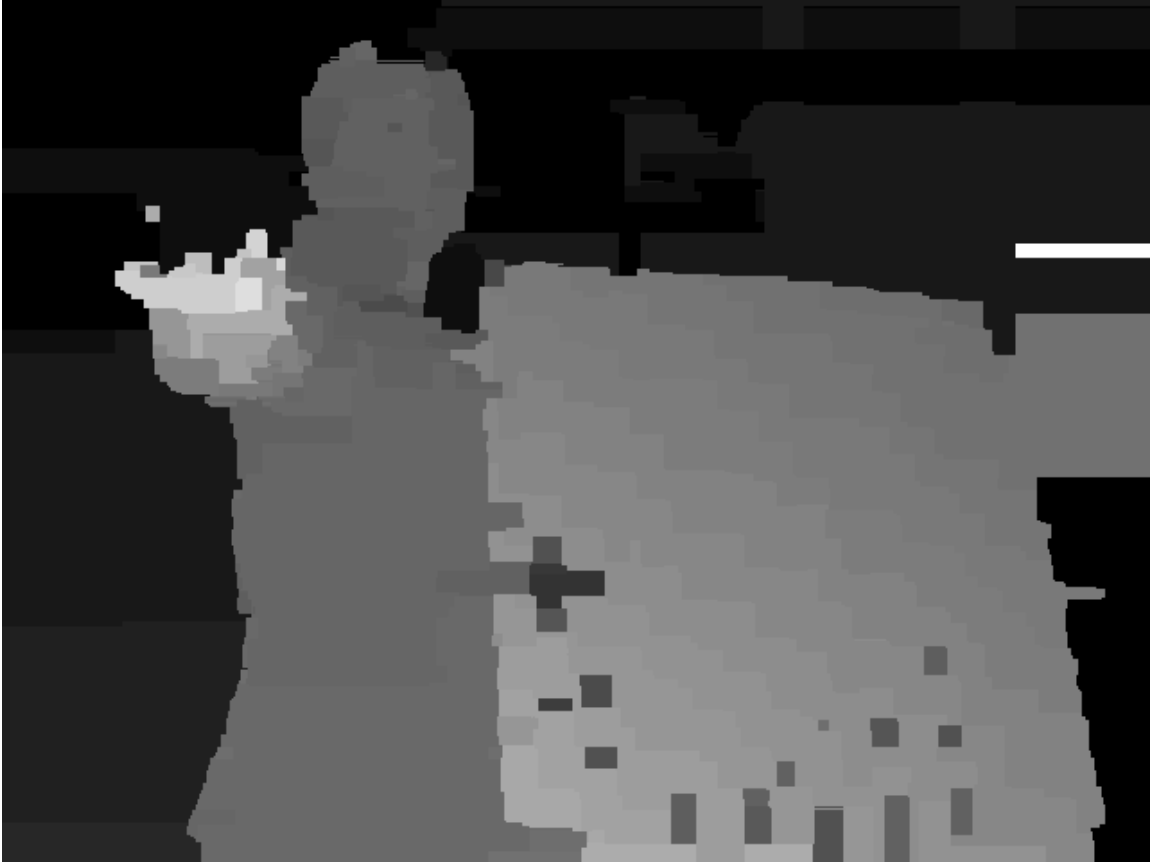
Şekil 3.23 Eşleme algoritması sonucu elde edilen stereo uzaklık haritası
