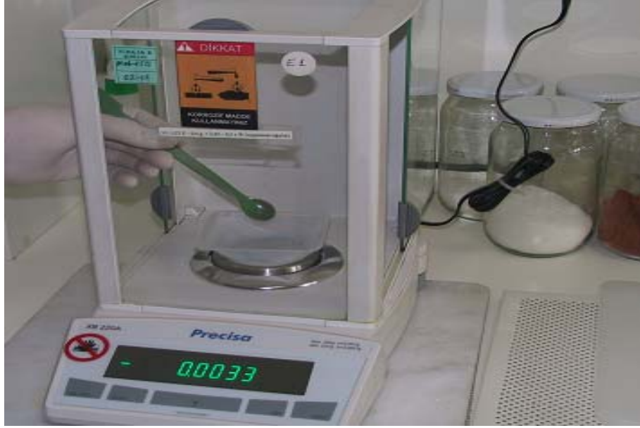
Şekil III.3. Numunelerin Hassas Terazide Tartılması
