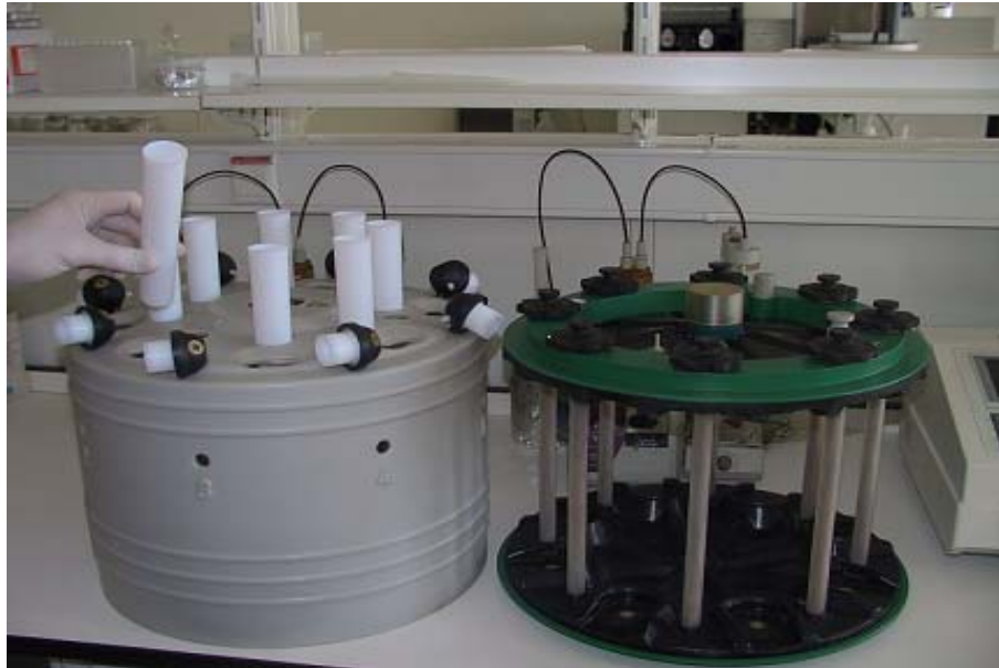
Şekil III.4. Örneklerin Mikrodalga Fırını Numune Kabına Konulması
