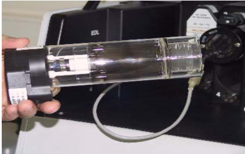
Şekil III.8. FAAS'da Bakır Elementinin Lambasının Cihaza Yerleştirilmesi
