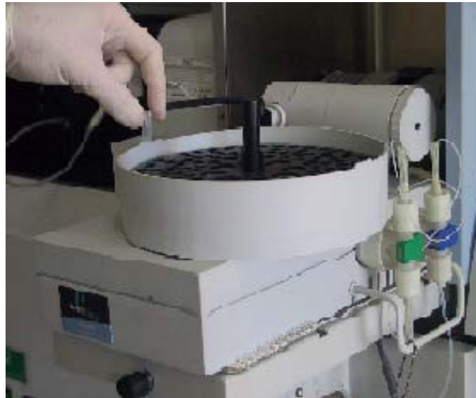
Şekil III.7. Grafit Numune Kabının Hazırlanması ve AAS Cihazına Yerleştirilmesi
