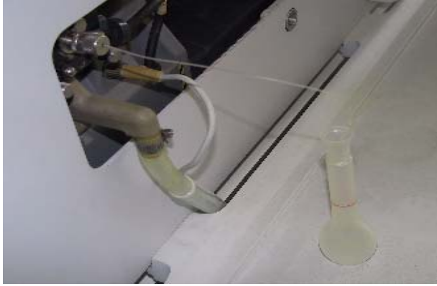
Şekil III.9. Numune Çekme Aparatının Balon Jojelerden Numune Çekmesi
