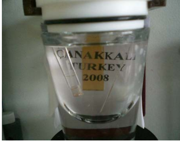
Şekil-4.28 SNS-Karb monomerinin elektropolimerizasyon ürününün (poli-SNS-Karb-2) İTO/cam yüzeyinde film şeklinde elde edildiği elektrokimyasal hücre.
