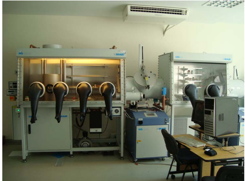
Şekil 4.2. Organik güneř pillerinin hazırlandığı “glow box” sistemi (Ege Üniversitesi-Güneř Enerjisi Enstitüsü).
