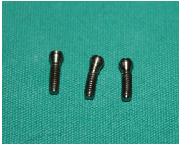
Şekil 4.15: Eğilen dayanak vidaları
