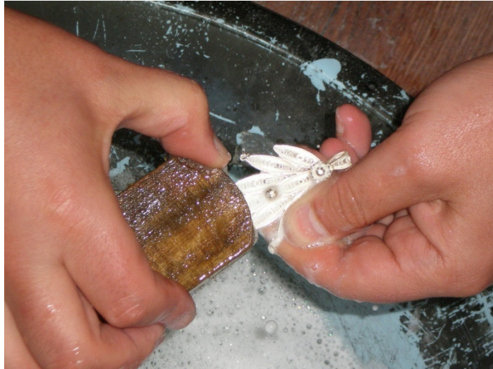
Fotoğraf 113: Ürünün deterjanlı su ile fırçalanması
