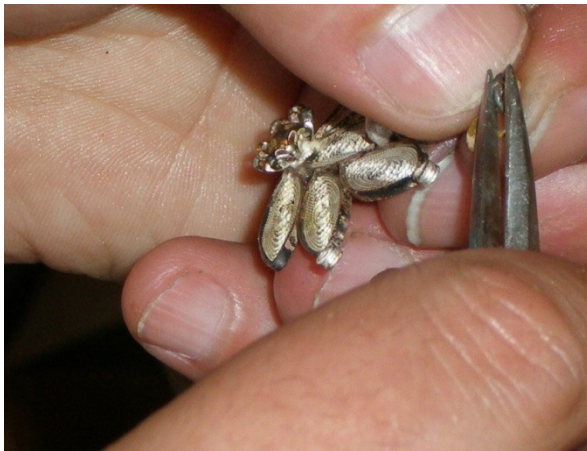
Fotoğraf 105: Uç kısımdaki halkalara pul takılması
