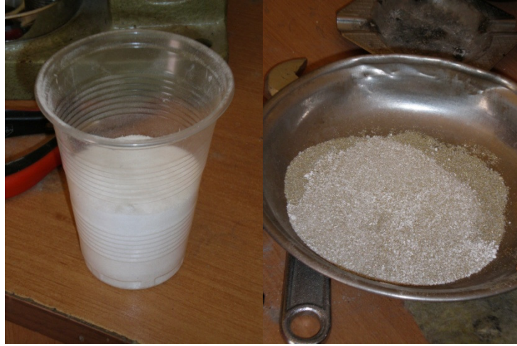
Fotoğraf 40-41: Toz boraks, kaynak-boraks karışımı
