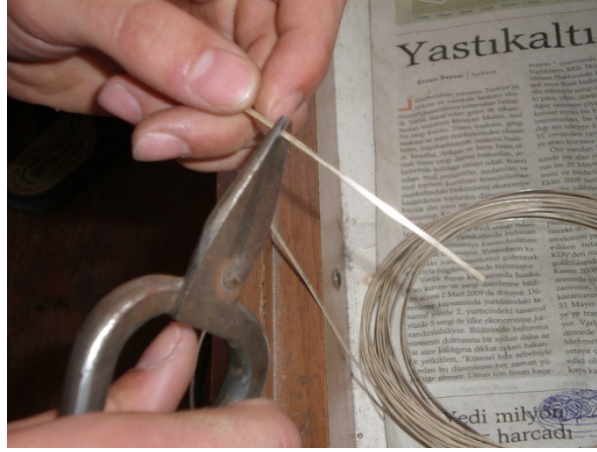
Fotoğraf 96: Yassı hale getirilen çatı telinin istenilen ölçüde kesilmesi
