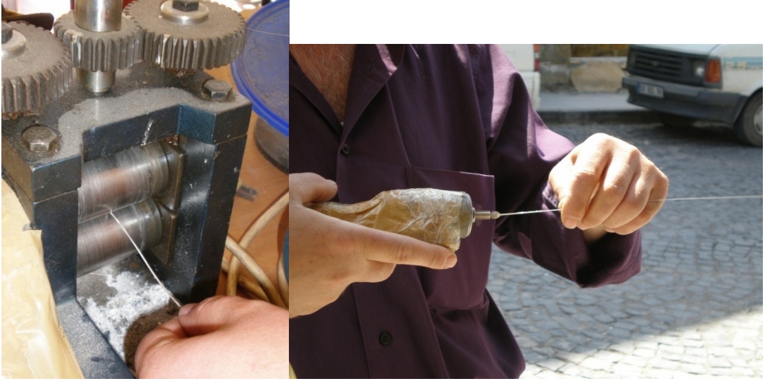
Fotoğraf 92-93: İstenilen inceliğe gelen tellerinin çatı teli olarak kullanılabilmesi için düz silindirden geçirilerek yassı hale getirilmesi ve dolgu teli olarak kullanılacak telin bükülmesi işlemi. Bükülen tel, çatı teli gibi silindirden geçirilerek yassı hale getirilir.
