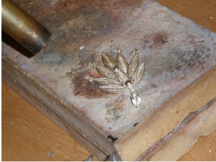
Fotoğraf 112: Asitli suda kaynatılan ürünün yıkandıktan sonra kurutulması
