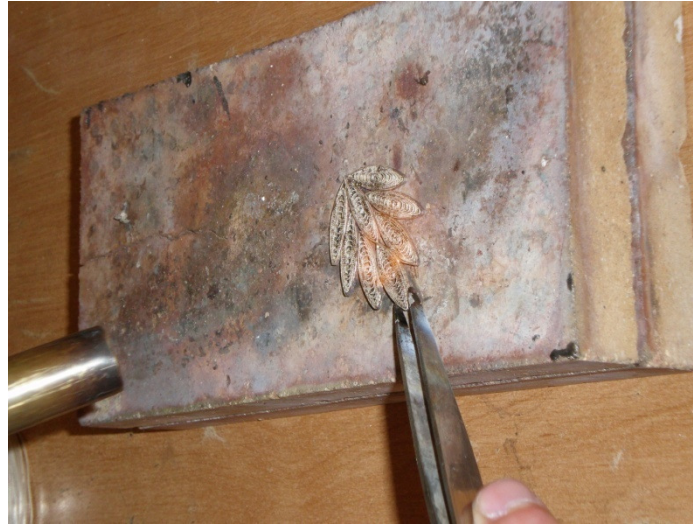
Fotoğraf 109: Toz kaynak-boraks karışımı dökülen modelin ateş tuğlası üzerinde şalome ile kaynatılması
