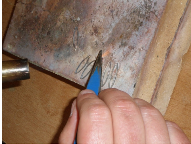
Fotoğraf 99: Şekil verilen tellerin uç kısımlarının kaynak ile birleştirilmesi
