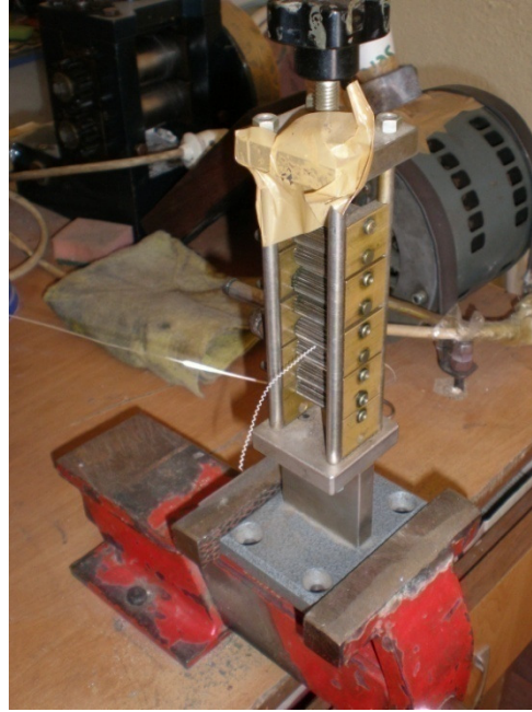
Fotoğraf 94: Eğer telkari de tırtır modeli uygulanacaksa dolgu teli tırtır makinesinden geçirilerek tırtıklı bir form verilir.
