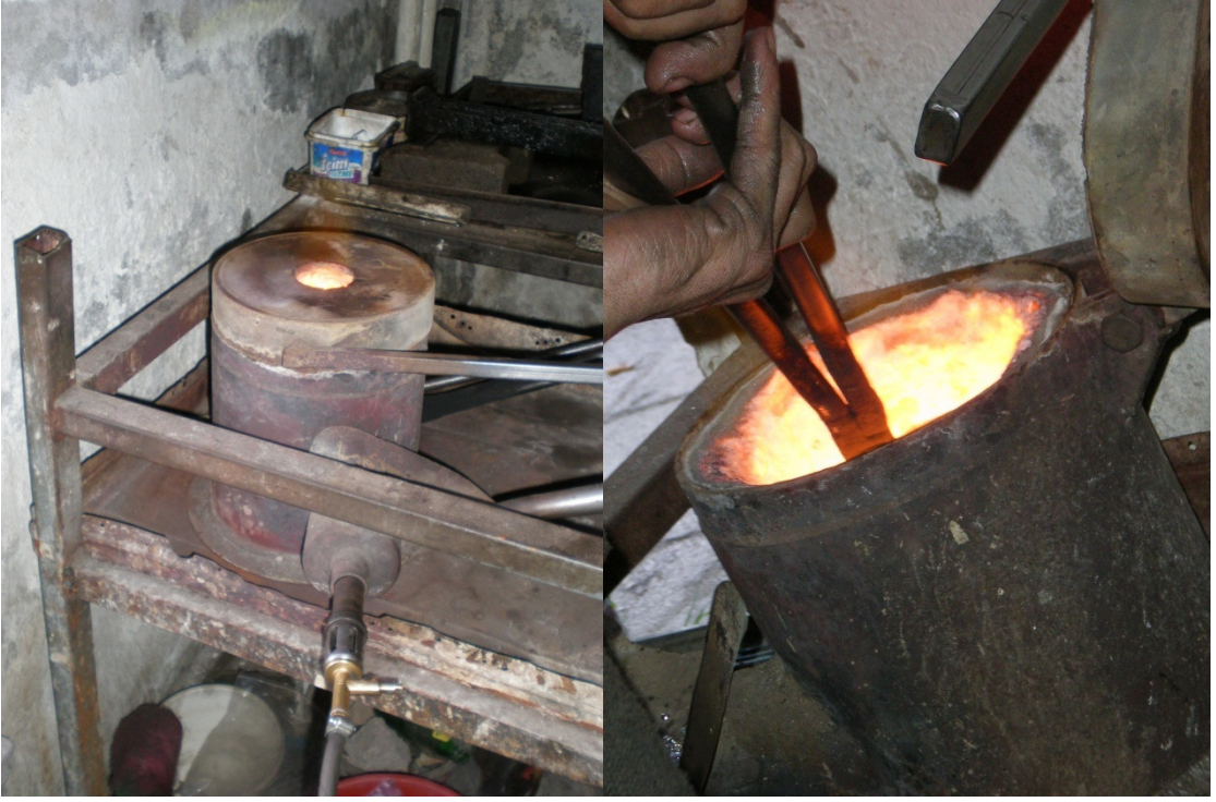
Fotoğraf 84-85: Saf gümüşün potada eritilmesi, eriyen gümüş kabının maşa ile alınması
