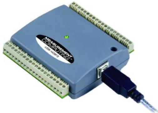
Şekil 5.3 Veri toplama kartı
