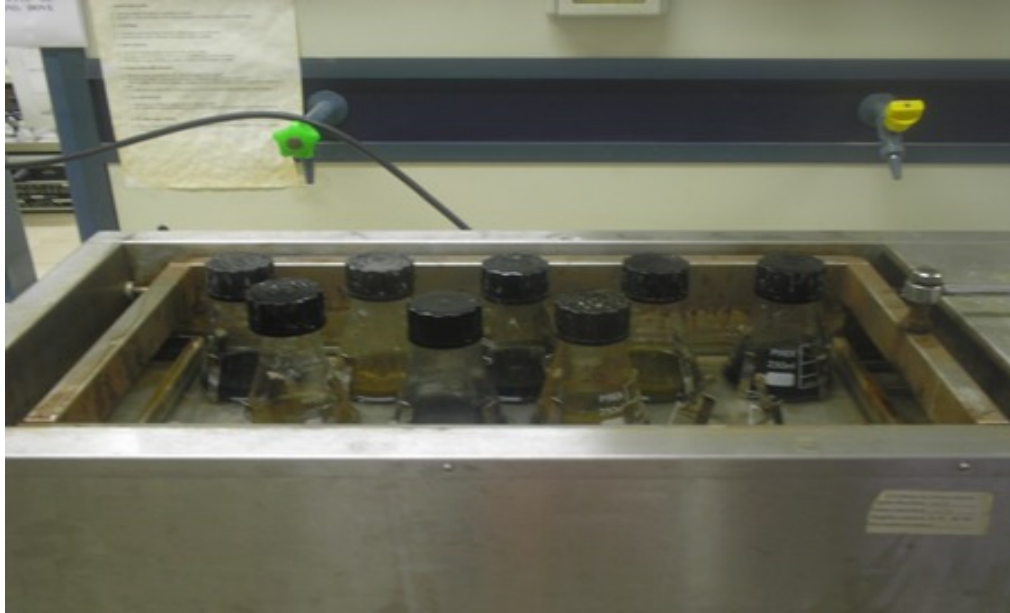
Şekil 3.2. Asidik liç deney düzeneği
