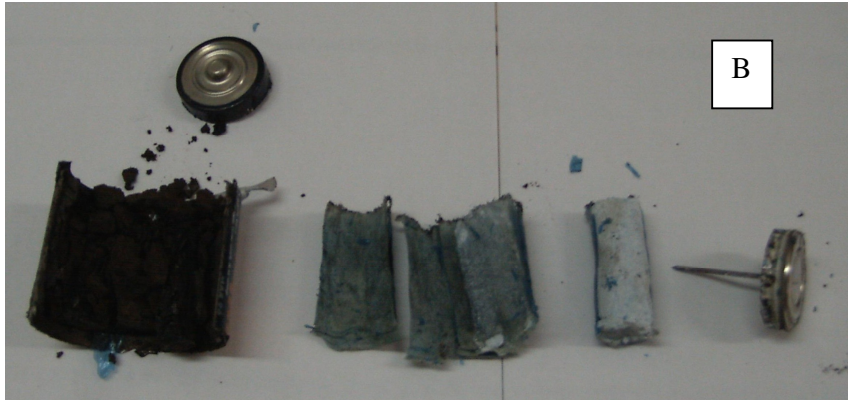
Şekil 3.4. Ön işlemler sonrası çinko-karbon (A) ve alkali (B) pil bileşenleri
