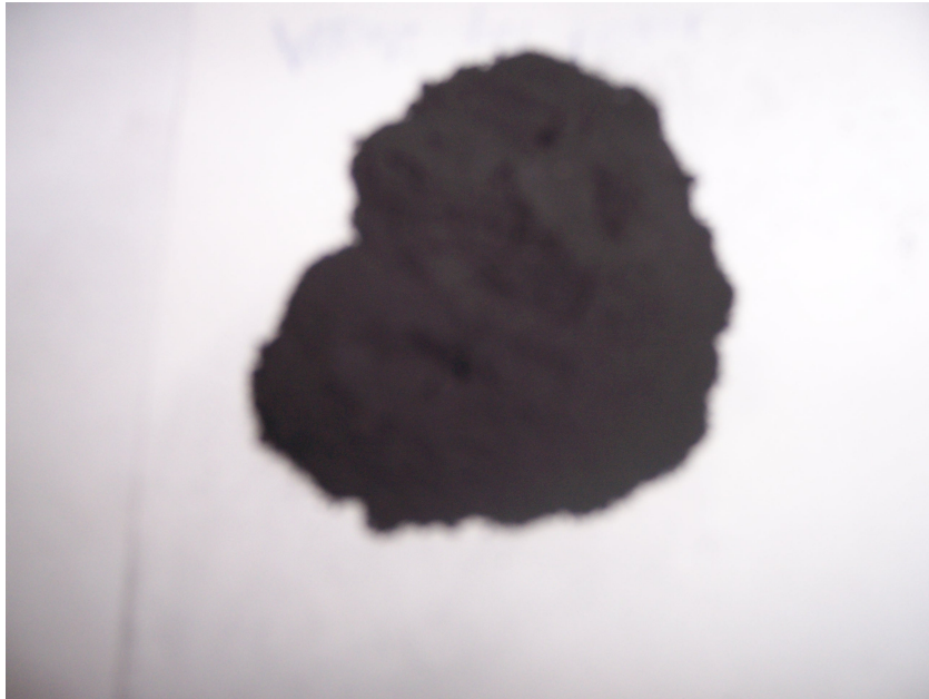
Şekil 3.5. Yıkanmış alkali pil tozu
