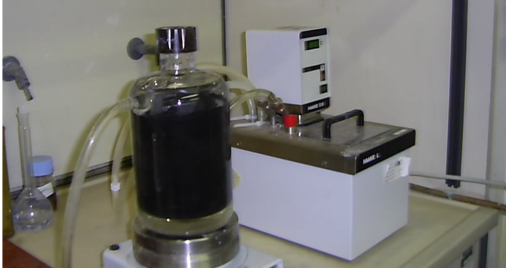
Şekil 3.1. Nötral liç deney düzeneği
