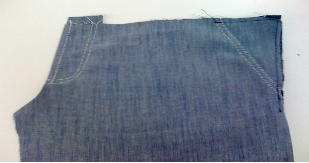
Şekil: 8.14 Kapalı patletin yerleştirilmesi
