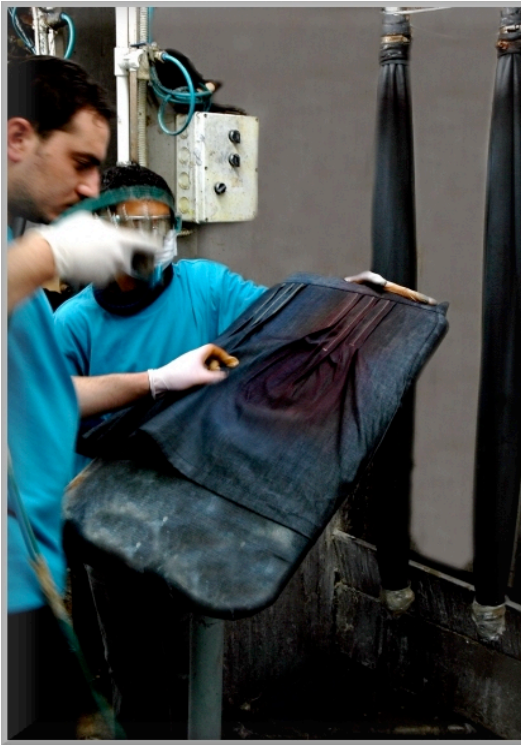
Şekil: 11.22 Sprey- Fırça kimyasal uygulaması
