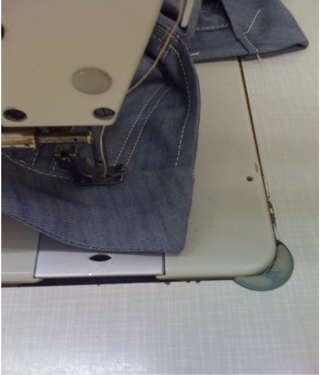
Şekil: 8.19 Kemer ucuna kapama dikişinin yapılması
