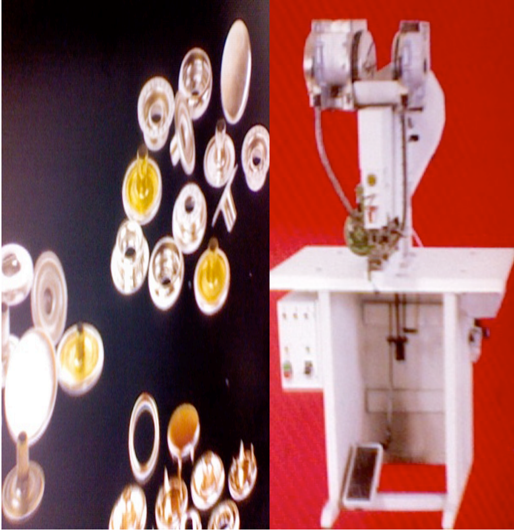
Şekil: 12.3 Çıtçıt ve çıtçıt çakma makinesi
