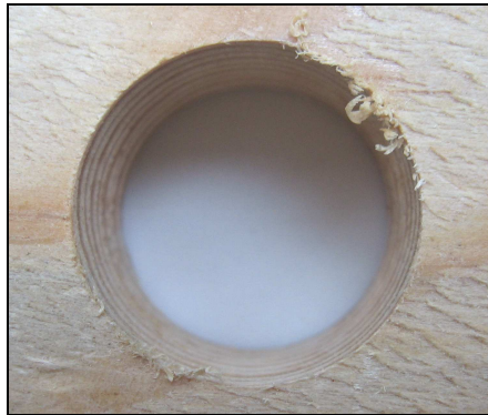
Şekil 4.29: Çam ağaç türünde çift helisli matkap ucu ile delik delme işleminde delik girişi (Foto.Sofuoğlu).
