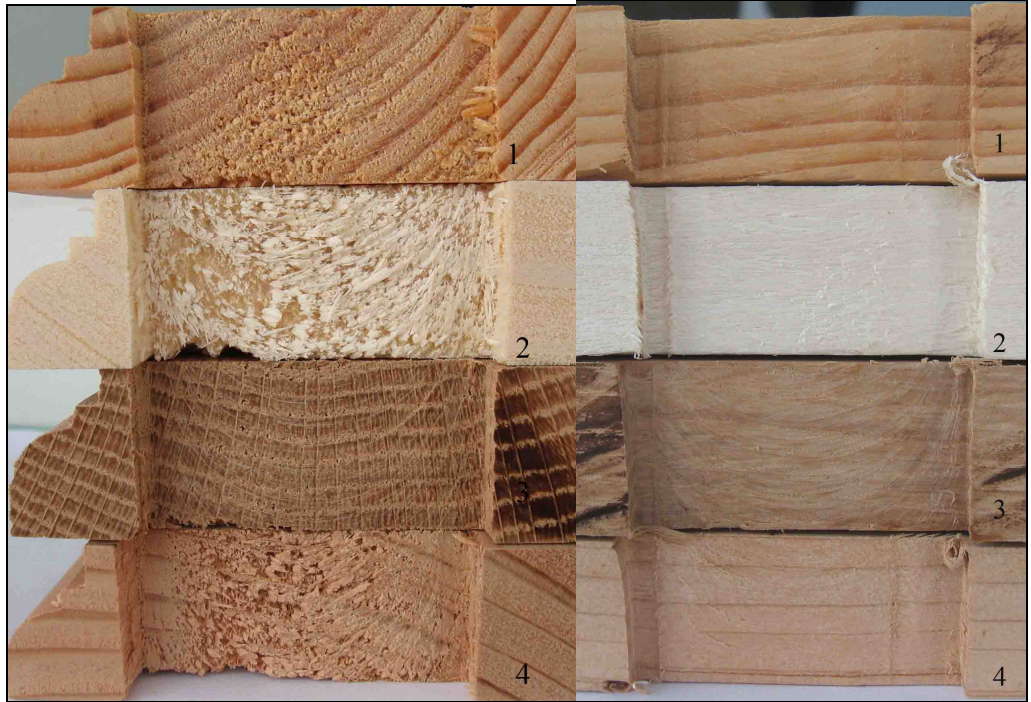
Şekil 4.24: Ağaç türlerine göre liflere paralel ve liflere dik zıvana açma işlemlerinde zıvana delik iç kısımları (1. çam, 2.kavak, 3. meşe, 4. sedir) (Foto.Sofuoğlu)
