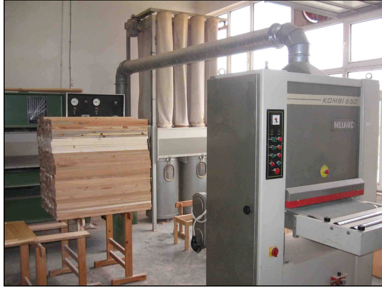
Şekil 3.16: Zımpara denemelerinde kullanılan Melkuç Kombi 650 model kalibre ve kontak geniş bant zımpara makinesi (Foto Sofuoğlu, Kartal E.M.L.)
