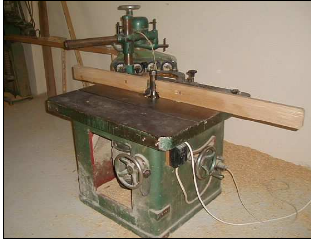
Şekil 3.12: Frezeleme denemelerinde kullanılan yatay (alt) freze makinesi (Foto.Sofuoğlu, İ.Ü.Orman Fakültesi)
