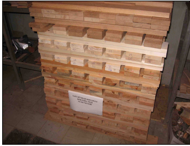
Şekil 3.7: İklimlendirme odasında bekletilen planyalama ve zımparalama numuneleri (Foto.Sofuoğlu, İ.Ü.Orman Fakültesi).
