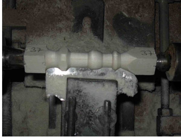
Şekil 3.30: Tornalama işleminin gerçekleştirilmesi (Foto.Sofuoğlu)
