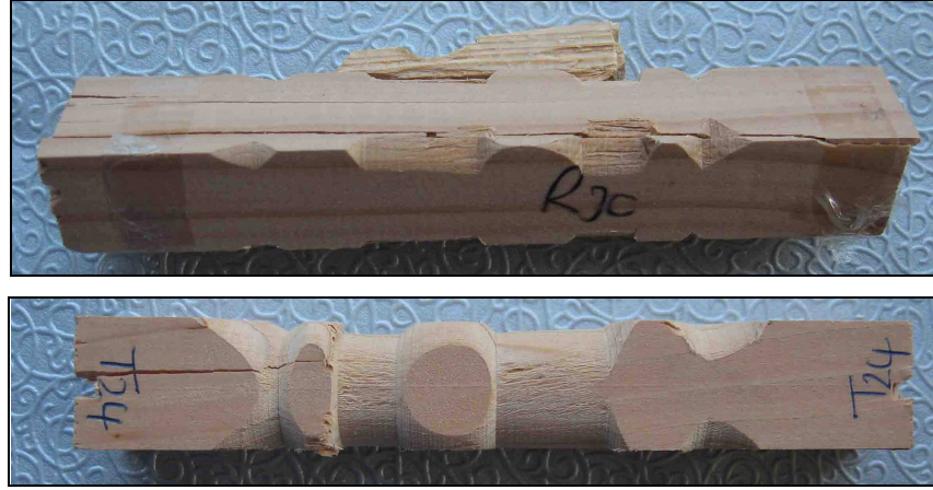
Şekil 4.32: Deneme başlangıcında (numunelerin makinaya takılması) ya da tornalama esnasında yarılan Sedir deney numunelerine örnekler (Foto.Sofuoğlu)
