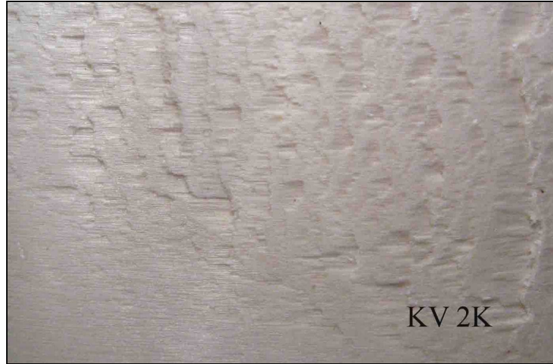
Şekil 4.5: Kavak 2. kesiş işlemi tipinde meydana gelen yongalı liflilik kusuru (Foto.Sofuoğlu)
