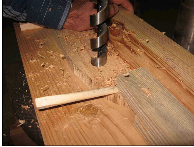
Şekil 3.28: Delik delme işleminin deney numunesi üzerinde gerçekleştirilmesi (Foto.Sofuoğlu)
