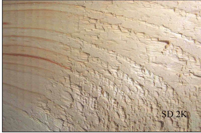
Şekil 4.7: Sedir 2. kesiş işlemi tipinde meydana gelen yongalı liflilik kusuru (Foto.Sofuoğlu)
