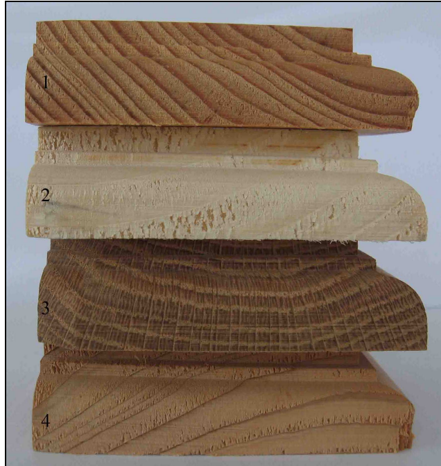
Şekil 4.18: Frezeleme işleminde liflere dik yönde kesişlerin meydana geldiği örnek deney numuneleri (1.çam, 2.kavak, 3.meşe, 4.sedir) (Foto.Sofuoğlu)
