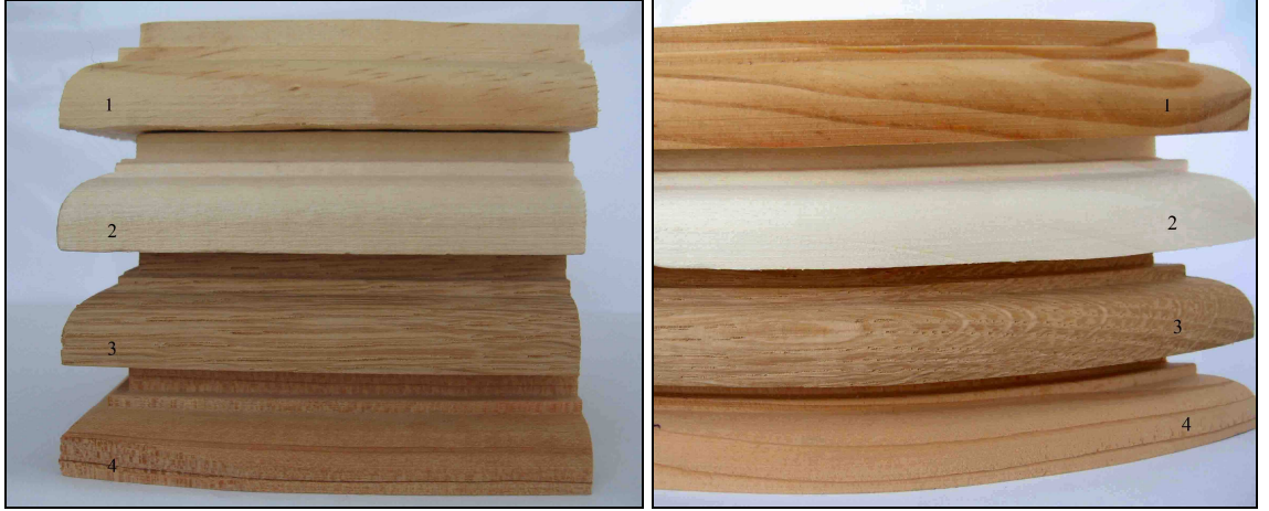
Şekil 4.17: Liflere paralel frezeleme işlemine örnek deney numuneleri (1. çam, 2. kavak, 3.meşe, 4. sedir) (Foto.Sofuoğlu)
