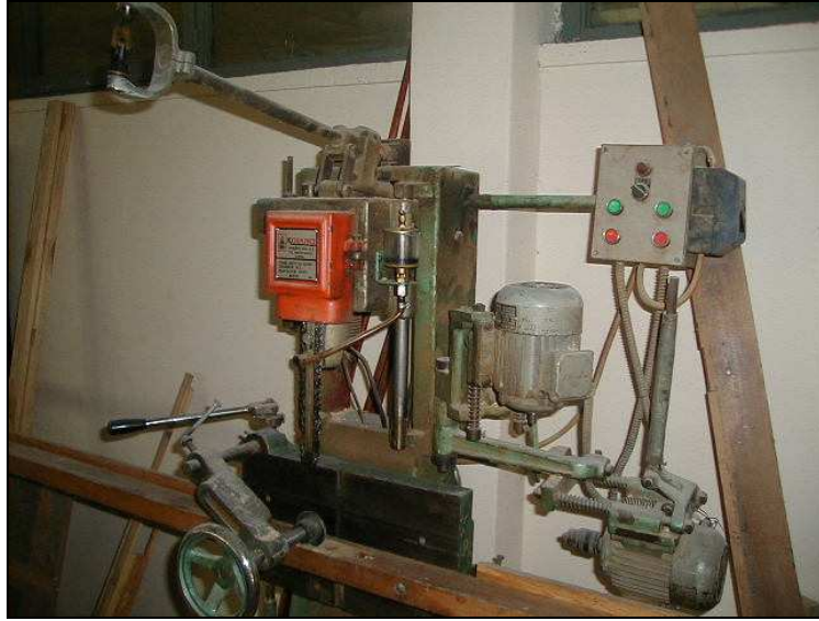
Şekil 3.11: Zıvana açmada kullanılan Kovancı marka zincirli zıvana açma makinesi (Foto.Sofuoğlu, İ.Ü.Orman Fakültesi)
