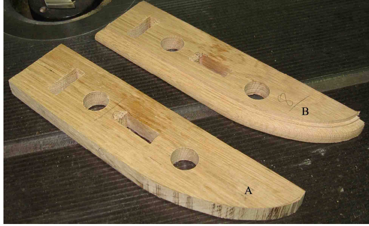
Şekil 3.24: Frezeleme işlemi uygulanmamış (A) ve freze işlemi uygulanmış (B) deney numunesi (Foto.Sofuoğlu)
