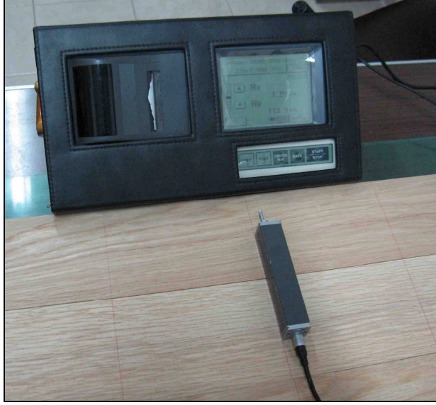
Şekil 3.34: Mitutoyo SurfTest SJ 301-yüzey pürüzlülük ölçüm cihazı ile meşe’de liflere dik ölçüm (Foto Sofuoğlu, İ.Ü.Orman Fakültesi)
