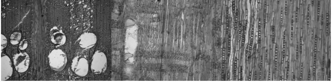
Şekil 3.3: Denemelerde kullanılan Quercus petraea (sapsız meşe) numunelerinden alınmış mikroskobik kesit (enine-radyal-teğet) görünüşleri (Foto. Tirak).
