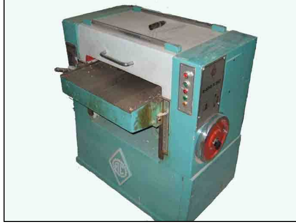
Şekil 3.13: Planyalama denemelerinde kullanılan TÖRK marka K500-X250 model kalınlık makinesi (Foto. Sofuoglu, İ.Ü.Orman Fak.).
