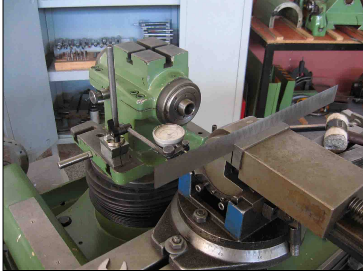
Şekil 3.20: Komparatör yardımıyla planya bıçağının yerleştirilmesi (Foto.Sofuoğlu, D.P.Ü.,S.T.E.F.)
