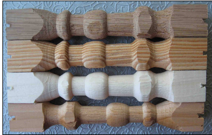
Şekil 4.33: Tornalanmış meşe, çam, kavak ve sedir deney numunelerinden birer örnek (Foto.Sofuoğlu)
