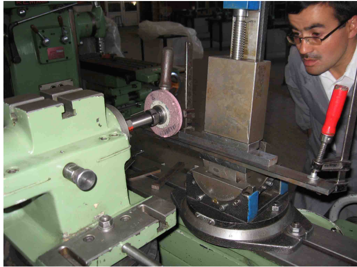
Şekil 3.21: Planya bıçağının tersten bilenerek kesiş açısının elde edilmesi (Foto.Sofuoğlu, D.P.Ü.,S.T.E.F.)
