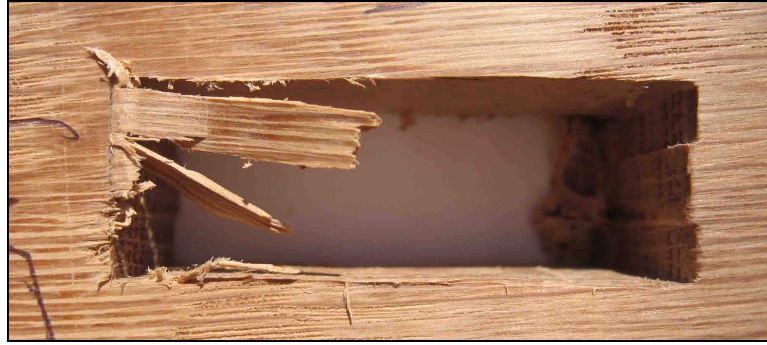
Şekil 4.23: Meşede liflere paralel zıvana açma işleminde zıvana deliği çıkışı (Foto.Sofuoğlu).
