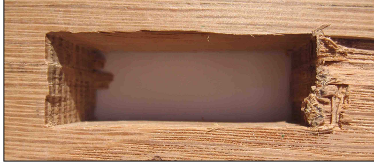
Şekil 4.22: Meşede liflere paralel zıvana açma işleminde zıvana deliği girişi (Foto.Sofuoğlu).
