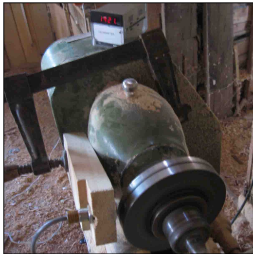
Şekil 3.31: Torna tezgahının devir sayısının dijital devir ölçer yardımı ile tespit edilmesi (Foto.Sofuoğlu)
