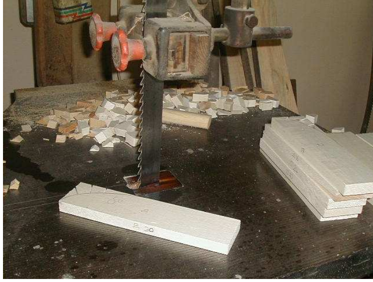
Şekil 3.8 Şerit testerede frezeleme denemelerinde kullanılacak olan kavisin gerçekleştirilmesi (Foto..Sofuoğlu, İ.Ü. Orman Fak.)
