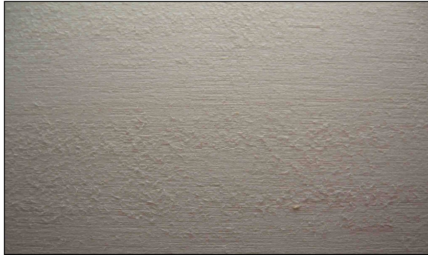
Şekil 4.36: Kavak odununun zımparalanmasında ortaya çıkan yünümsü pürüzlü görünüm (Foto.Sofuoğlu)
