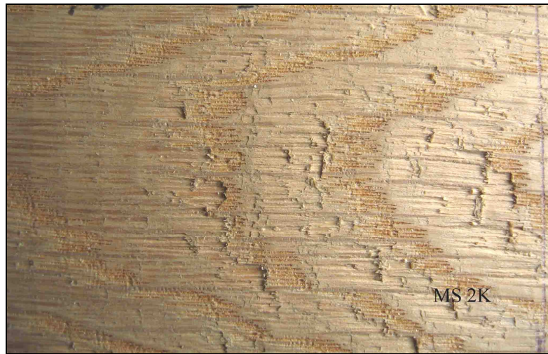
Şekil 4.6: Meşe 2. kesiş işlemi tipinde meydana gelen yongalı liflilik kusuru (Foto.Sofuoğlu)
