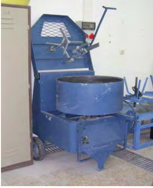
Şekil 3.10. Beton Üretiminde kullanılan beton mikseri
