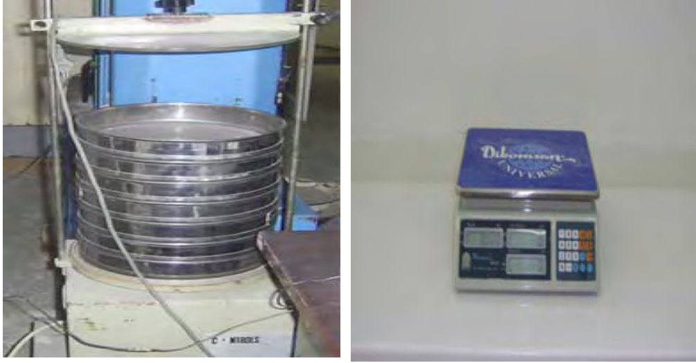
Şekil 3.1. Elek analizinde kullanılan elek takımı, elek sarsma makinesi ve terazi
