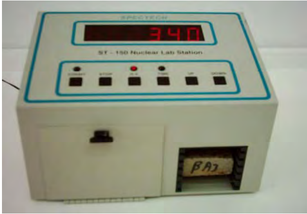
Şekil 3.6. Radyasyon deneyinde kullanılan radyasyon sayacı
