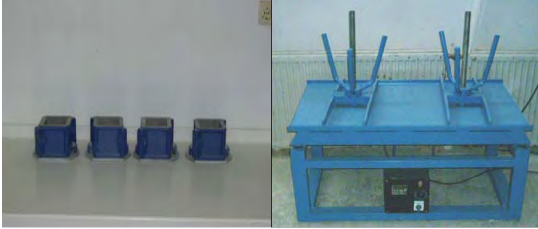
Şekil 3.11. Beton üretiminde kullanılan 150mm kübik kalıplar ve sarsma tablası
