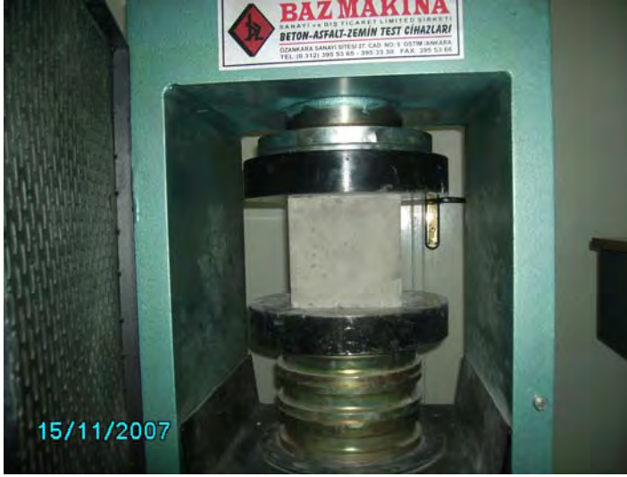
Şekil 3.3. Basınç deneyinde kullanılan 300 ton kapasiteli beton presli
