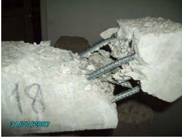
Şekil 4.6. Eğilme deney sonucu kırılma biçimi
