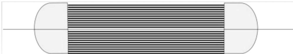
Şekil 3.5 Filaman sarmal patern polar sarmal şematik gösterimi [50].
