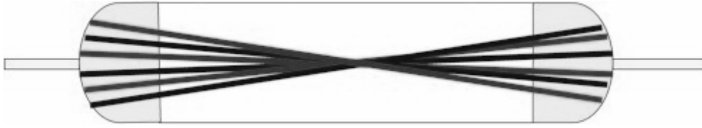
Şekil 3.4 Filaman sarmal patern helikal sarmal şematik gösterimi[50].
