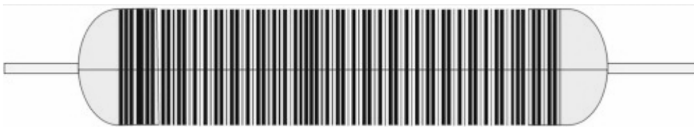
Şekil 3.3 Filaman sarmal patern kasmak sarmalı şematik gösterimi[50].
