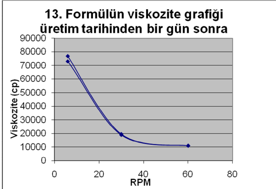
Şekil 5: 13. Formülasyonun viskozite grafiği üretim tarihinden 24 saat sonra
