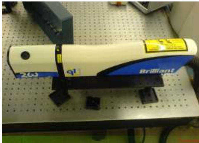
Şekil 3.3 Quantel Brilliant Nd: Yag lazeri
