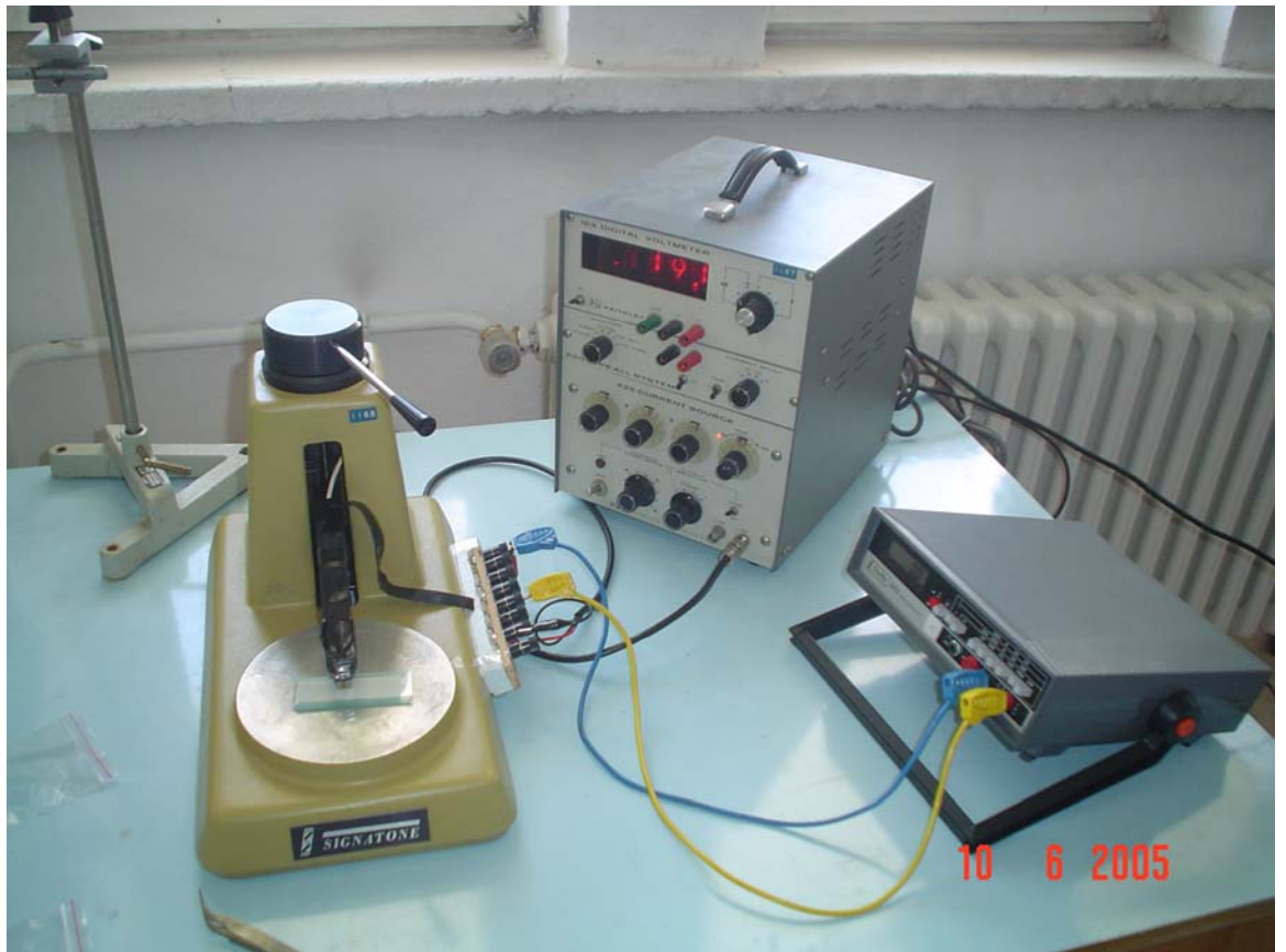
Şekil 3.4. Omik kontak direnci ölçümünde kullanılan deneysel düzenek
