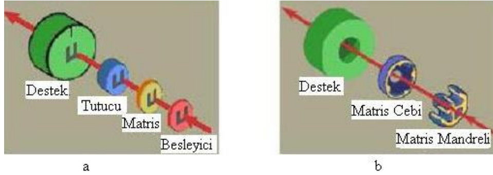
Şekil 1.19 Düz ve odalı matris a-)Düz matris ve takımları, b-)Odalı (porthole) matris ve takımları (AEC)
