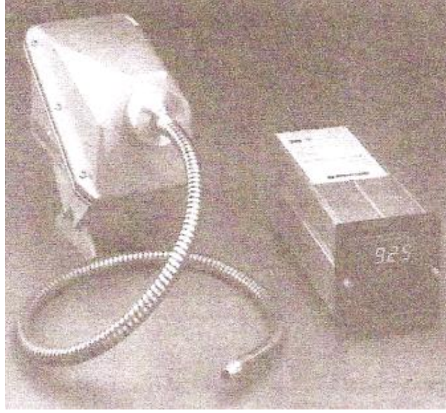
Şekil 4.19 Tipik bir temassız sıcaklık ölçme ünitesi (Saha, 2000)
