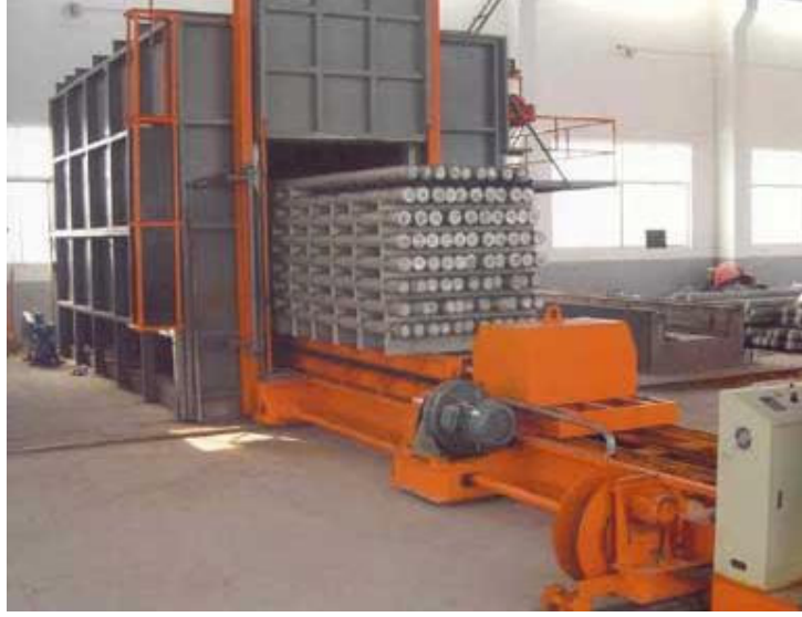
Şekil 1.21 Alüminyum blok homojenleştirme fırını (Nokta Metal)
