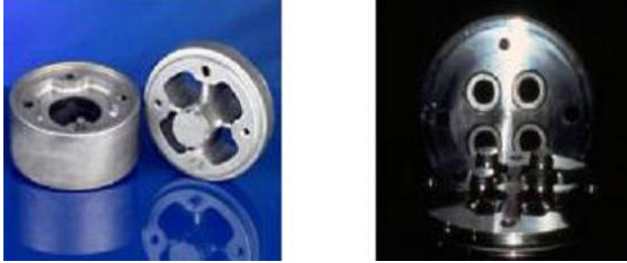
Şekil 1.13 İçi boş profiller için açık (içi boş) matris örnekleri (AEC)
