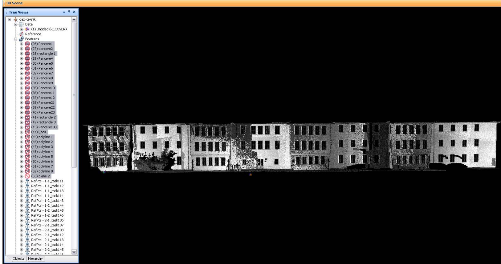
Şekil 5.50. Cephenin 3 ayrı yerinden yapılan taramanın birleştirilmiş hali
