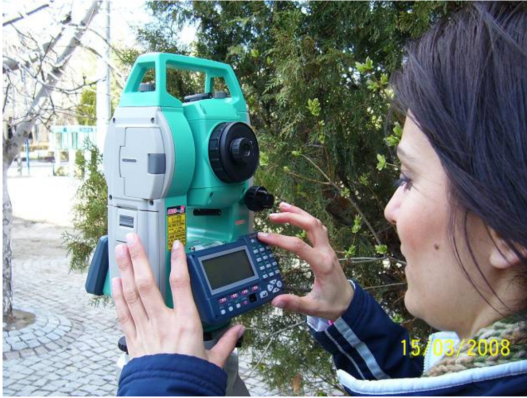
Resim 5.4. Önden kestirmede kullanılan SOKKIA SET 30RK model total station
