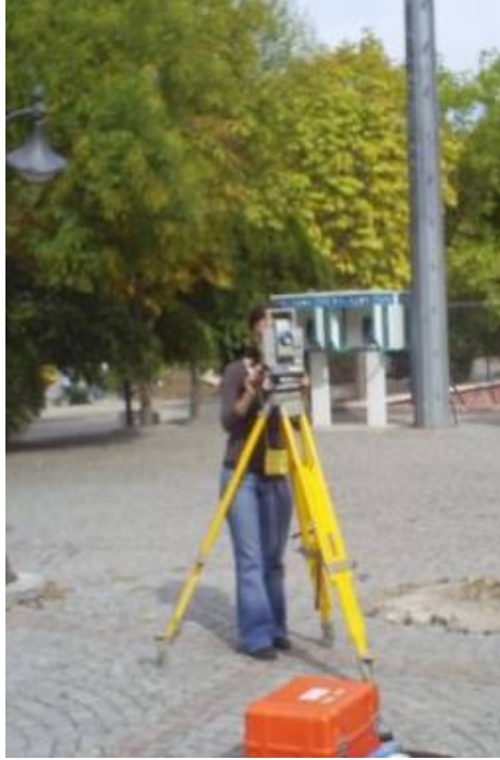
Resim 5.10. Kutupsal koordinat yöntemi ile (SET 2B Model Total Station) ölçüm yapılması
