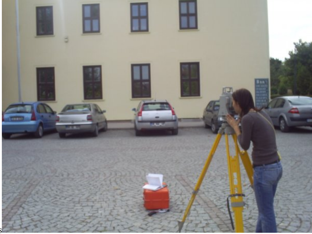
Resim 5.3. Kutupsal koordinat yöntemi ile (SET 2B Model Total Station) ölçüm yapılması
