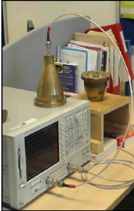
řekil 3.25. ASTM D 4935 standardına göre geliřtirilmiř dairesel eřeksenli iletim hattı test düzeneđi
