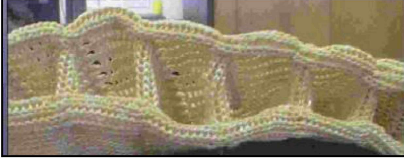
Şekil 1.24. Örölmüş tabakalarla birbirine birleřtirilmiř iki ayrı örme kumař yüzeyinin oluřturduđu bir tekstil yapısı (Stoll katalogu)
